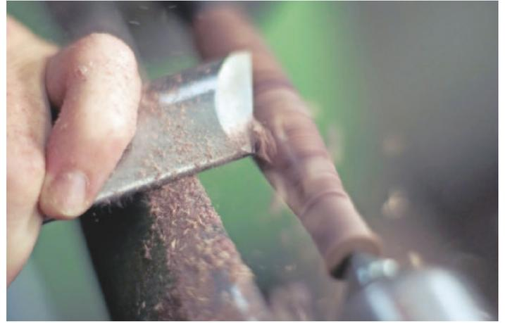
*/ Kontemplatives Tun: Span um Span wird vom vorgedrehten Rohling mit dem Drechsel-Meißel abgenommen und ihm so die gewünschte Form gegeben.*
